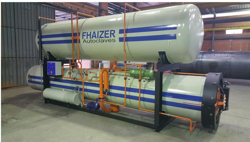
Figura 5 – Autoclave com tanque reservatório em cima/sobre o cilindro de tratamento, conhecido como “double-deck”. Fonte: Fhaizer Autoclaves
