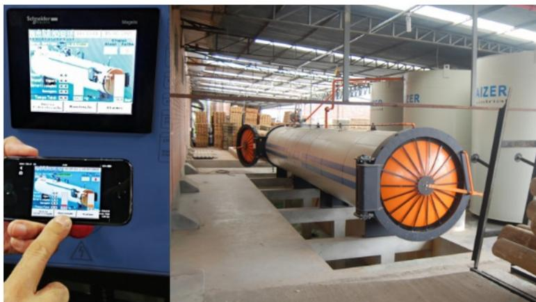
Figura 6 – Autoclave completamente automatizada com sistema *wi-fi*. Fonte: Fhaizer Autoclaves
