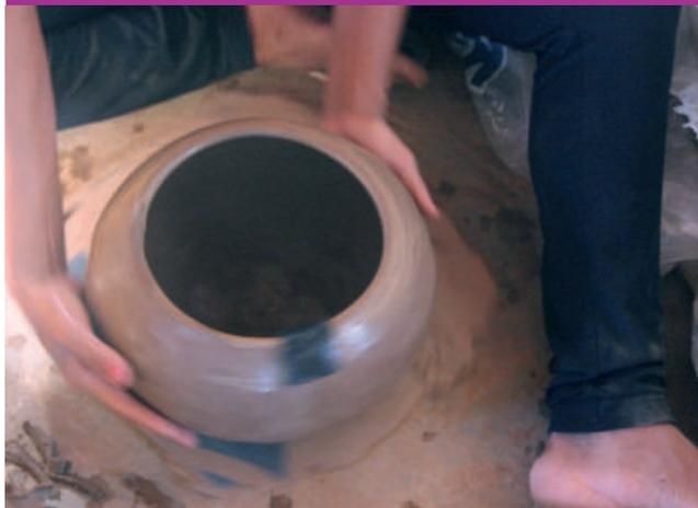
Se nivelan sus bordes con un cuchillo, y se pone la pieza a secar
