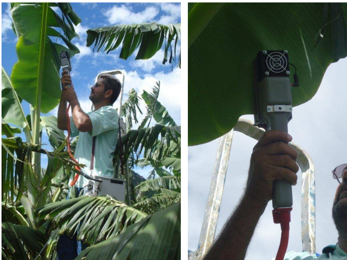
Figura 4 - Avaliações das trocas gasosas realizadas com o analisador de gás a infravermelho (IRGA) modelo Lcpro + ® Portable Photosynthesis System (ADC BioScientific Limited, UK) com temperatura e irradiância ambiente e fluxo de ar de 200 ml min -1 . Guanambi, BA, 2010-2012.
