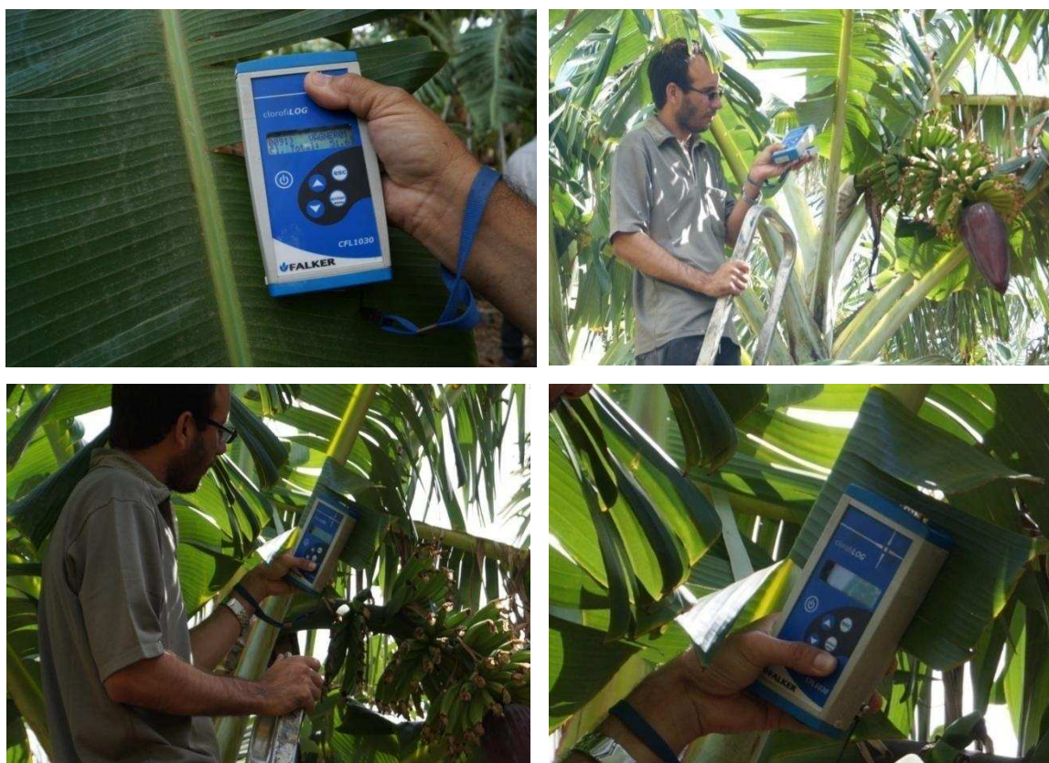
Figura 1 - Avaliações para estimativas dos índices de clorofila com o Clorofilômetro-Clorofilog CFL1030 da Falker. Guanambi, BA, 2010-2012.
