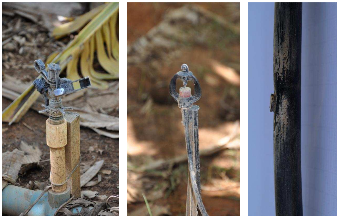
Figura 5 - Detalhes dos emissores utilizados nos sistemas de irrigação por aspersão convencional subcopa, microaspersão e gotejamento. Guanambi, BA, outubro de 2009 a setembro de 2010.
