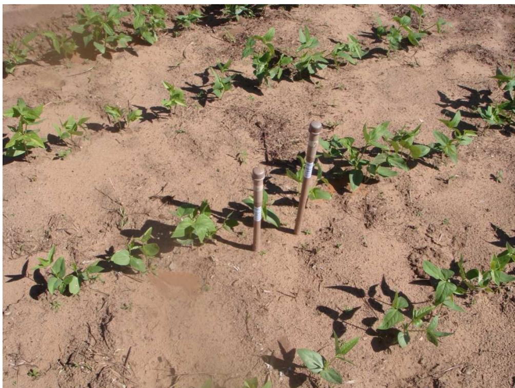
Figura 7. Tubos tensiométricos instalados na cultura do feijão-caupi, com as cápsulas porosas a 0,10 e 0,30 m de profundidade.
