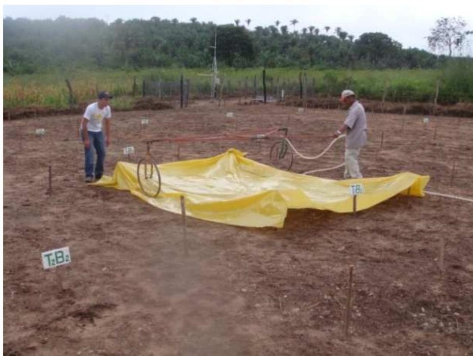
Figura 13. Medição das perdas por evaporação e arraste pelo vento.
