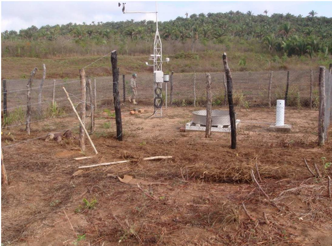
Figura 9. Estação meteorológica automática instalada na área experimental.
