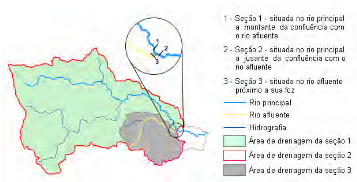
Figura 9 - Procedimento para a determinação das vazões a montante e a jusante da confluência do rio com equação ajustada e um afluente direto. (Fonte: Moreira, 2006)
