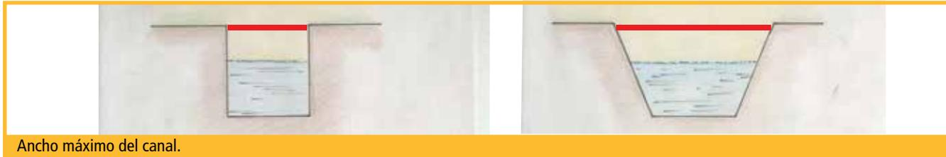
Elementos de un canal » **Coronamiento**
