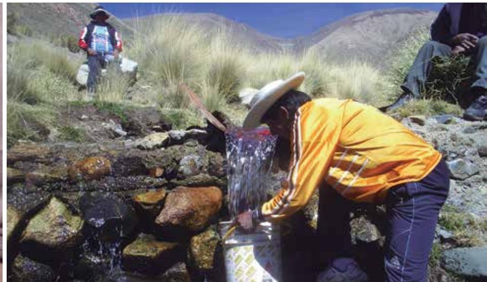
Mediciones de caudal mediante método volumétrico.
