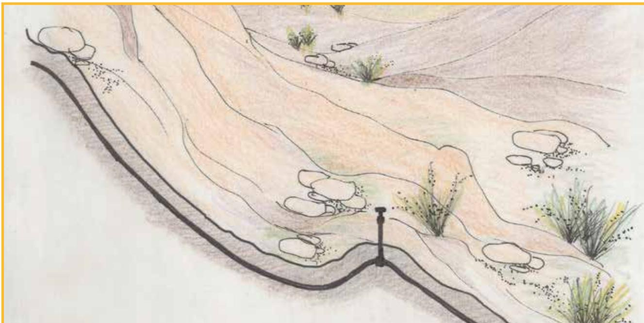
Donde encontremos una lomada o una elevación en la conducción es conveniente ubicar una válvula de purga.
