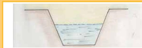
Realizamos los cálculos con distintos tamaños de base de fondo y distintos tirantes, hasta obtener a partir de la sección y la velocidad, el caudal de diseño de nuestro proyecto.
