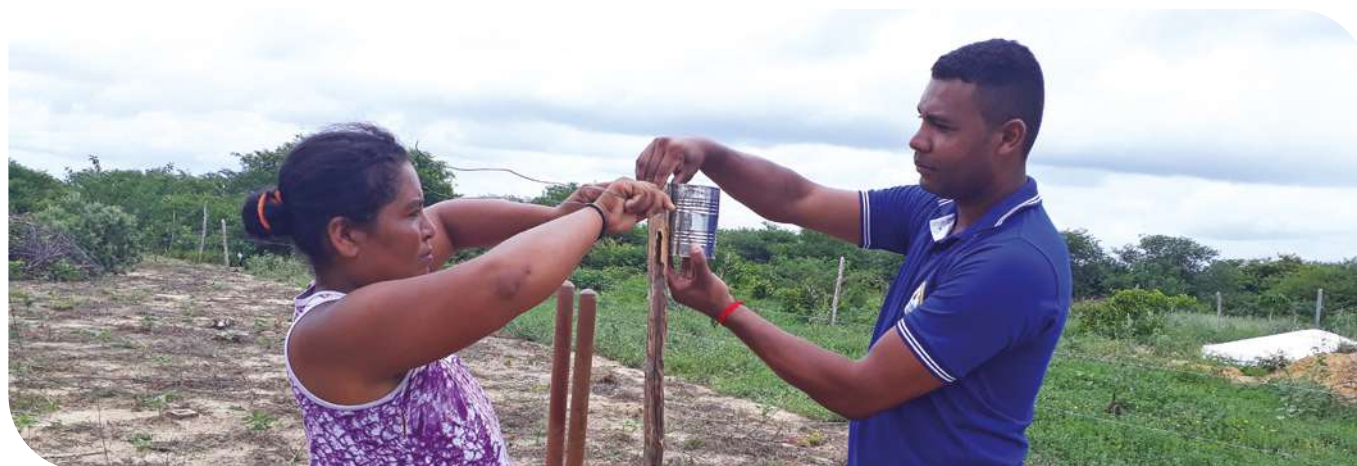
Instalação do pluviômetro caseiro na unidade de produção da beneficiária Luzia Marques, Assentamento Terra Nossa, Ponto Novo-BA.
