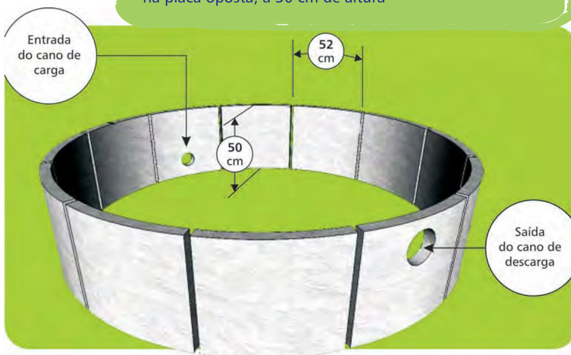
[Figura 13] Disposição das placas na parede do tanque. Cano de Entrada a 10 cm de altura do fundo e o de saída, na placa oposta, a 30 cm de altura
