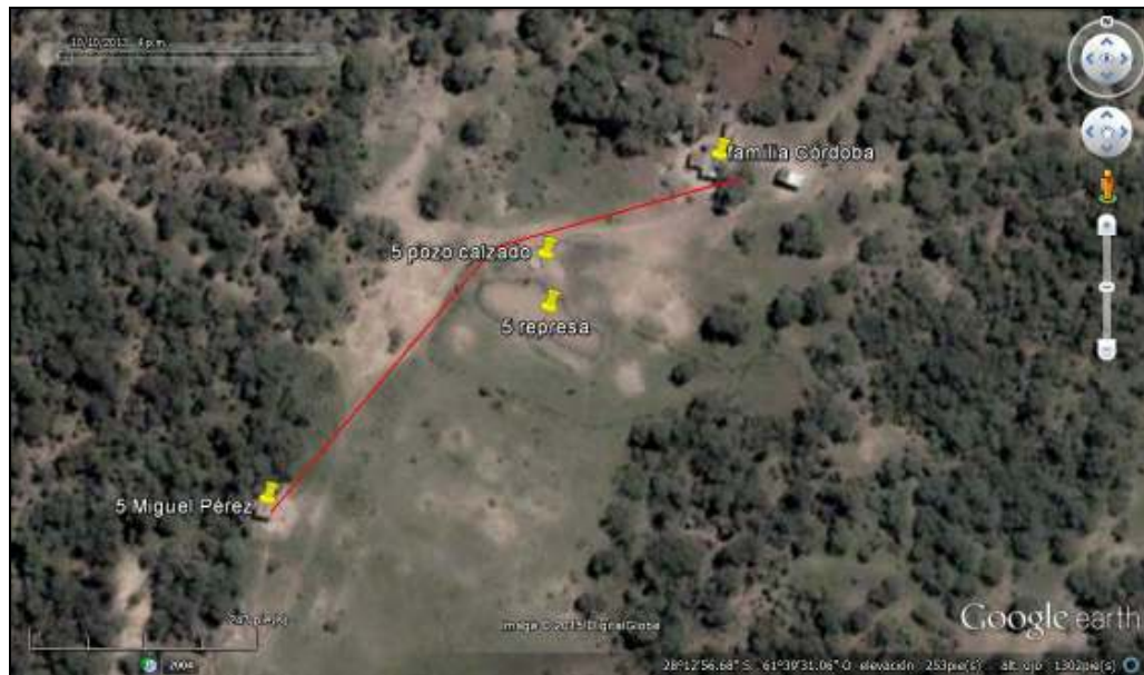
Imagen satelital donde se visualizan los 200 m de cañería propuestos para las familias Córdoba y Pérez.
