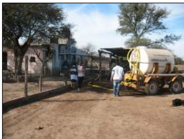
Aljibe actual reabastecido con agua subterránea de una aguada cercana.
