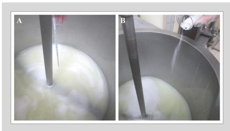
**Figura 3** - Aquecimento do soro de leite até 65 °C (A) e adição do bicarbonato de sódio (B).
